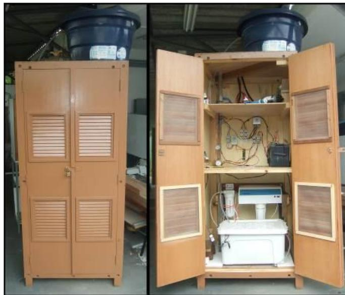
**Figura 21 – O Sistema Fotovoltaico de Dessalinização configurado para testes de funcionamento de longo período**
