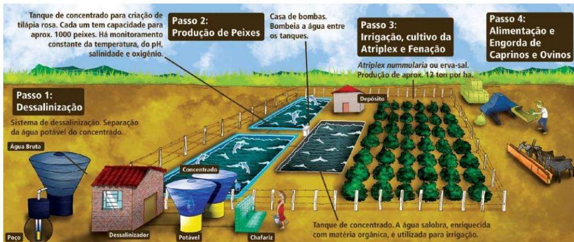
**Figura 11 – Esquema da unidade demonstrativa do sistema de produção integrado do Projeto Água Doce**
