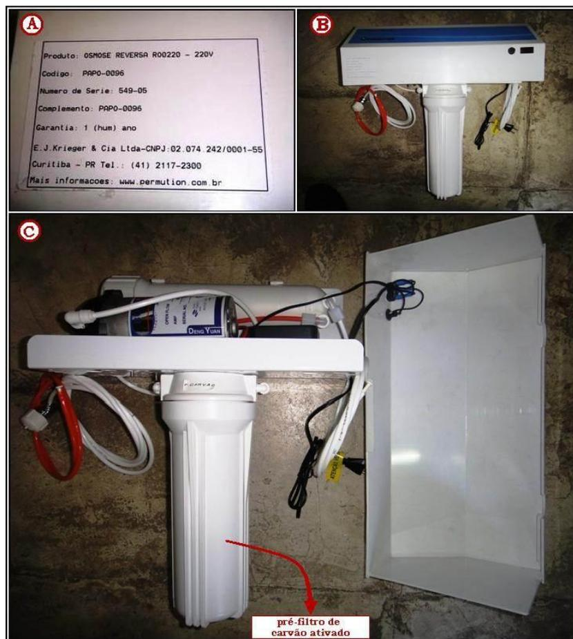
**Figura 12 – Foto do sistema de osmose reversa Evolution RO-0220, da Permution – Soluções em Água**
