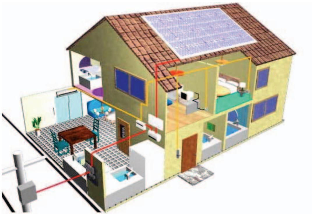
**Figura 2.** Esquema de uma casa com instalação fotovoltaica conectada à rede elétrica de baixa tensão: com painéis, medição e equipamentos de consumo.
