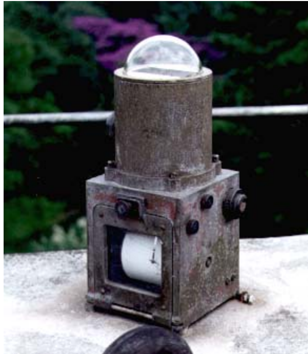
Figura 4.1.2. Fotografia de um actinógrafo instalado no IAG/USP - Água Funda [Oliveira,1997].
