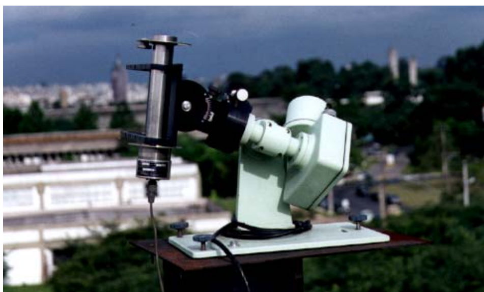
Figura 4.1.5. Fotografia de um piroheliômetro [Oliveira, 1997].
