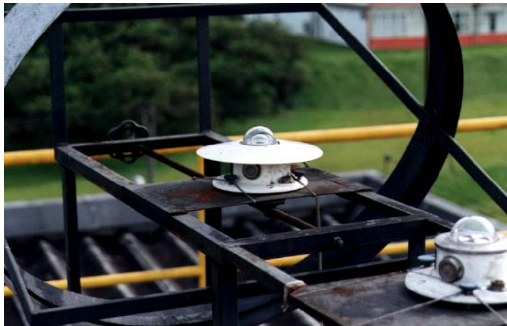
Figura 4.1.4. Fotografia de dois piranômetros termelétricos [Oliveira, 1997].
