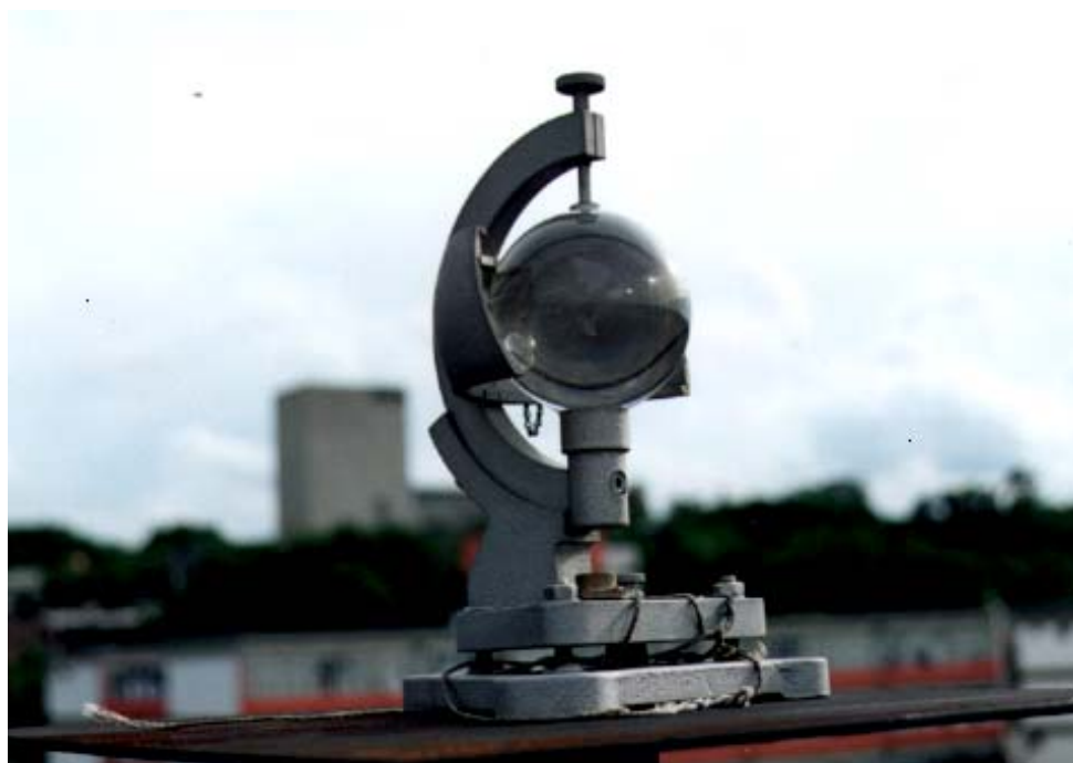
Figura 4.1.1. Fotografia de heliógrafo instalado no IAG/USP - São Paulo [Oliveira,1997].
