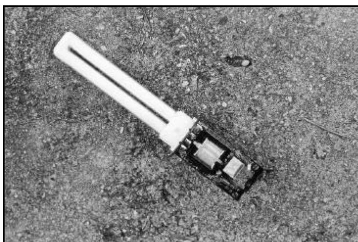
Figura 2.25: Luminárias de 11W com lâmpada e reator formando conjunto único e não desacoplável.
