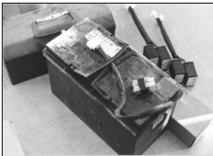
Figura 2.7: Bateria sem bornes com SmartSwitch™ embutido e dispositivos de controle do SmartSwitch™.
