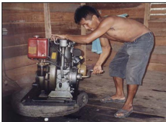
Figura 3.6. Gerador a óleo diesel utilizado na comunidade de São João – município de Atalaia do Norte - Amazonas [Foto: F. Morante, 08/12/2003]
