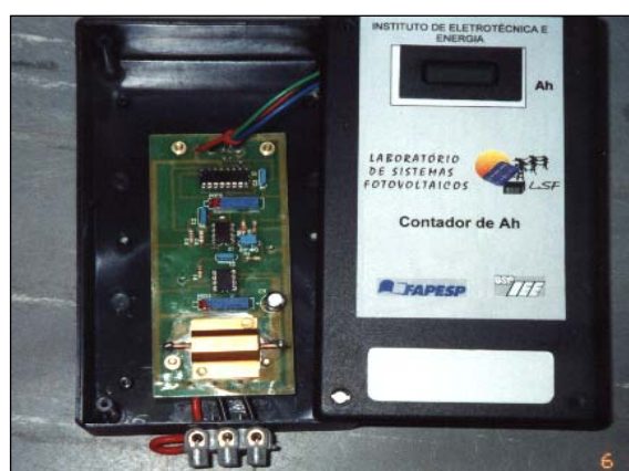
Figura 1.3. Vista da placa, da caixa e a parte frontal do medidor de Ah. [Foto: F. Morante, 06/11/2000]
