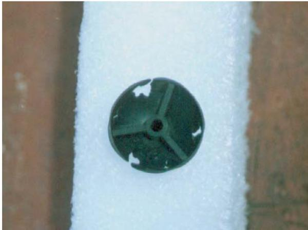
Figura 3.9 – Diafragma de bomba danificado pela grande quantidade de areia em suspensão existente na água bombeada, AM. (Foto: M.C. Fedrizzi, 2003)
