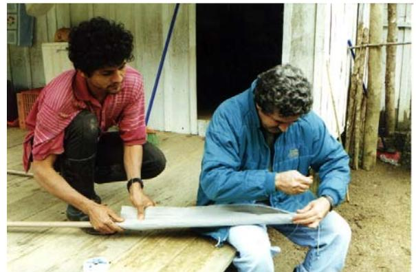
Figura I.15 Confecção dos filtros dos poços. (Foto: M.C. Fedrizzi, 1998)
