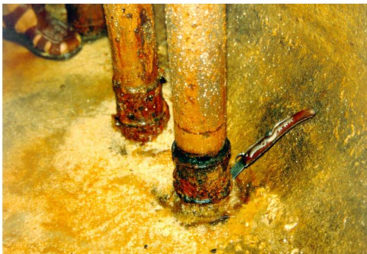
Figura 3.26 – Tubulação de ferro galvanizado perfurada por corrosão.
