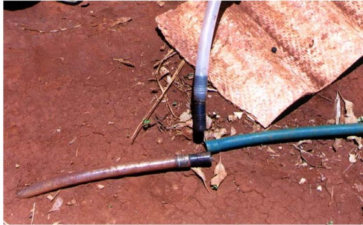
Figura 3.25 – Conexão de polietileno apresentando rompimento.
