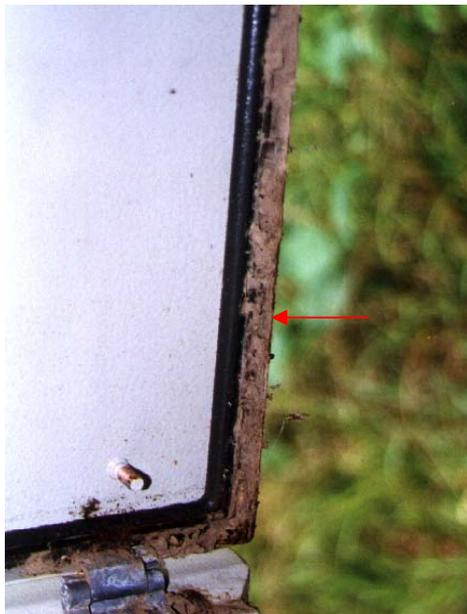
Figura 3.31 – Borracha de vedação danificada por insetos, RO. (Foto: M.C. Fedrizzi, 2000)
