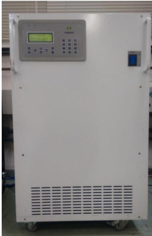
**Figura 3-6 - Fonte c.a. para simulação de rede elétrica da marca Supplier.**
