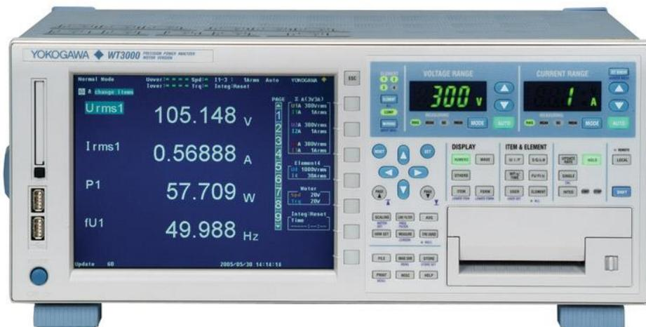
Figura 3-12 - Vista frontal do analisador de energia Yokogawa WT3000
