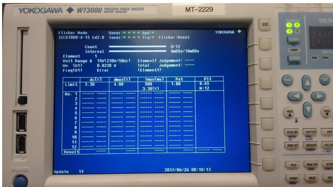
Figura 4-10 - Mostrador do equipamento Yokogawa WT3000 para o teste de cintilação.
