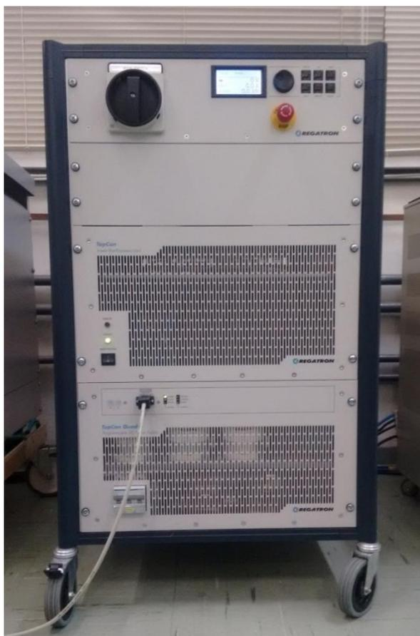
Figura 3-2 - Fonte c.c. para simulação de arranjos fotovoltaicos da marca Regatron.
