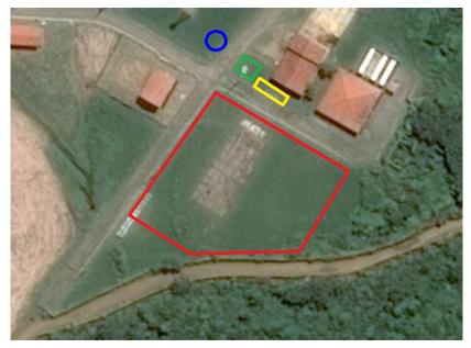
Figura B.6 – Visão aérea da área onde a usina foi instalada, onde polígono vermelho – geradores fotovoltaicos; círculo azul – ponto de conexão à rede; quadrado verde – estação solarimétrica; e retângulo amarelo – eletrocentro.
