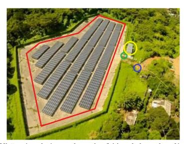
Figura B.10 – Visão aérea da área onde a usina foi instalada, onde polígono vermelho – geradores fotovoltaicos; círculo azul – ponto de conexão à rede; círculo verde – estação solarimétrica; e círculo amarelo – casa de força.
