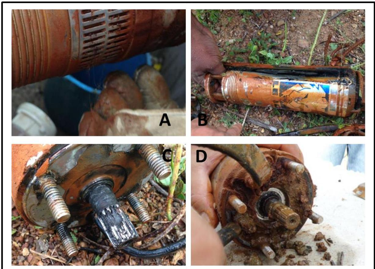
**Figura 4.14: Problemas nas motobombas.** (a) Raízes capilares obstruindo a entrada da bomba, (b) Degradação do emborrachado do cabo elétrico, (c) Corrosão da ponta do eixo entalhada e (d) Presença de areia no acoplamento motor-bomba
