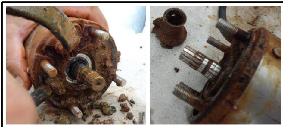
**Figura 5.5: Retirada da areia do motor e ponta de eixo desgastada**
