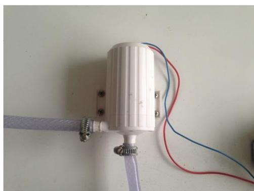
Figura 3 - Bomba de superfície utilizada na montagem.
