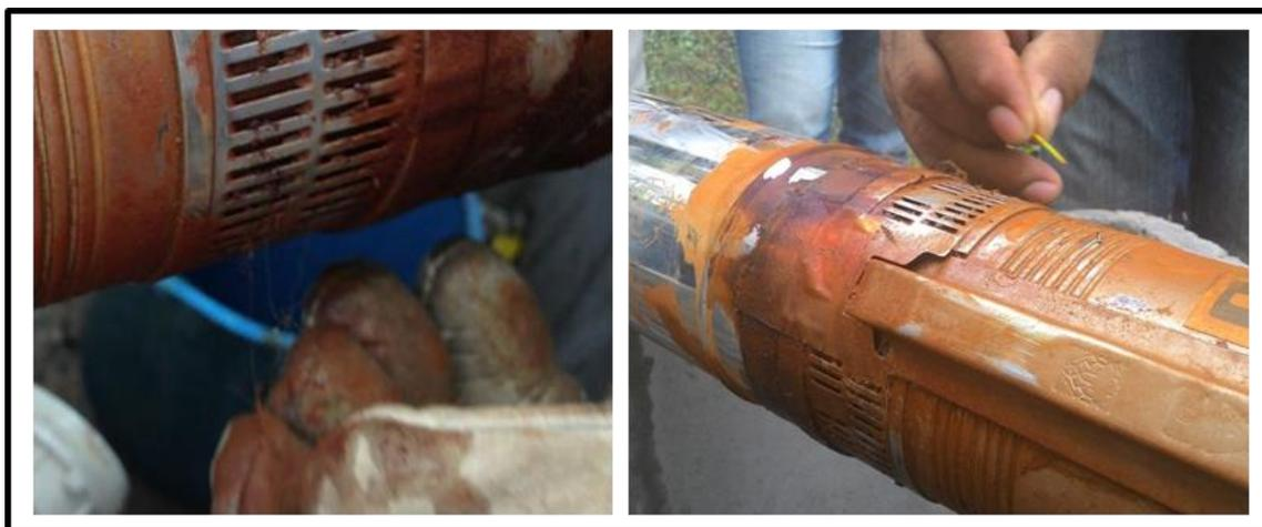
**Figura 5.6: Presença de raízes na bomba**
