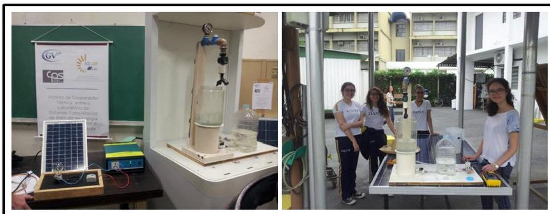
**Figura 5.25: Kit didático de bombeamento fotovoltaico**
