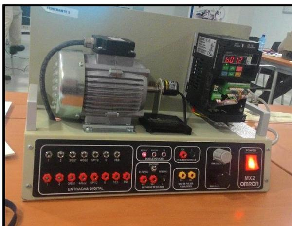
**Figura 5.21: Bancada de ensaio para treinamento do uso de CF**
