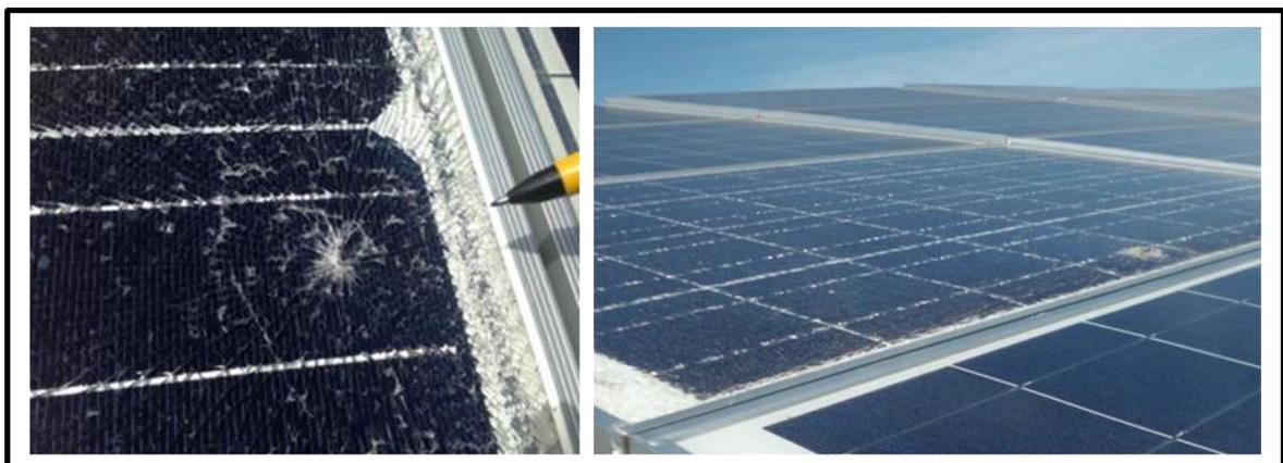
**Figura 5.16: Ocorrências detectáveis pelos usuários dos SFB-CF – gerador fotovoltaico danificado**
