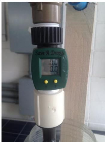
Figura 5 - Hidrômetro digital utilizado na montagem.
