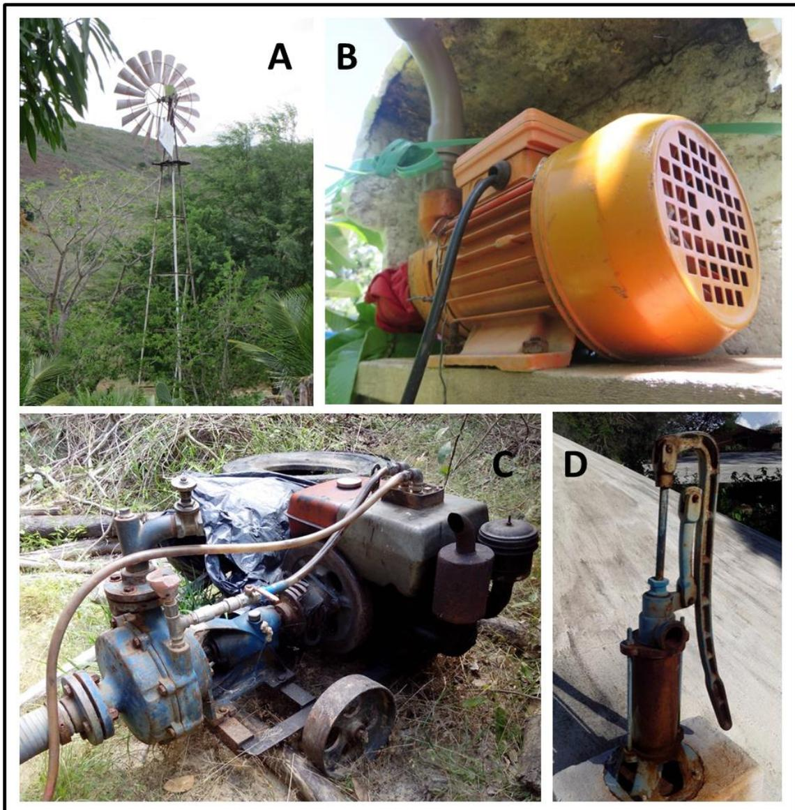
**Figura 1.1:** Exemplos de sistemas de bombeamento utilizados no nordeste brasileiro: (A) cata-vento, (B) bomba com a rede, (C) gerador a diesel e (D) bomba manual
