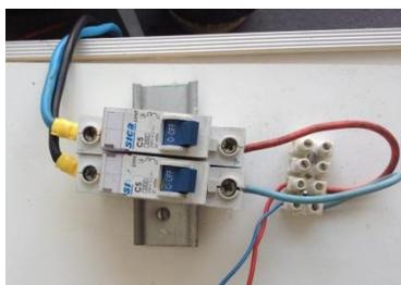
Figura 6 - Par de disjuntores e terminal de plástico utilizados na montagem.
