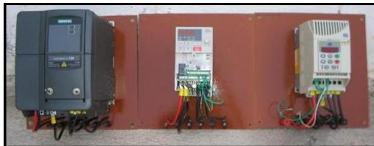
**Figura 3.4: Modelos de CFs testados por Brito (2006)**
