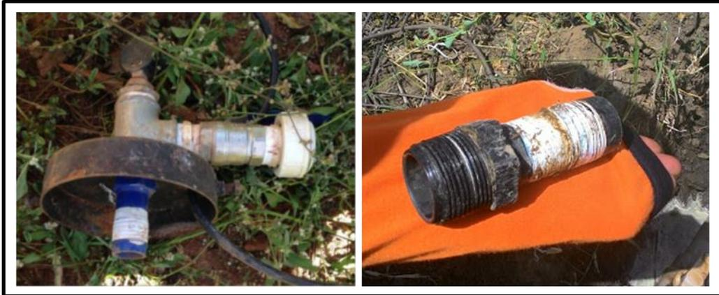
**Figura 5.4: Espigão de plástico usado para conectar a tampa do poço com a mangueira da bomba**
