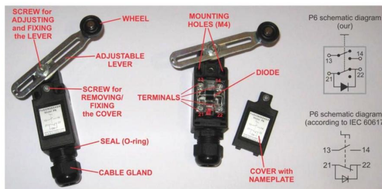
Figura 18. Componentes do Interruptor fim de curso FUSIONSEEKER P6 [2].
