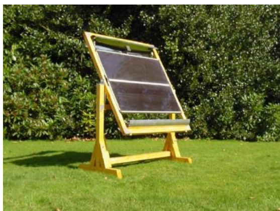
Figura 2.18 - Protótipo de um seguidor solar passivo acionado por tiras bimetálicas.
