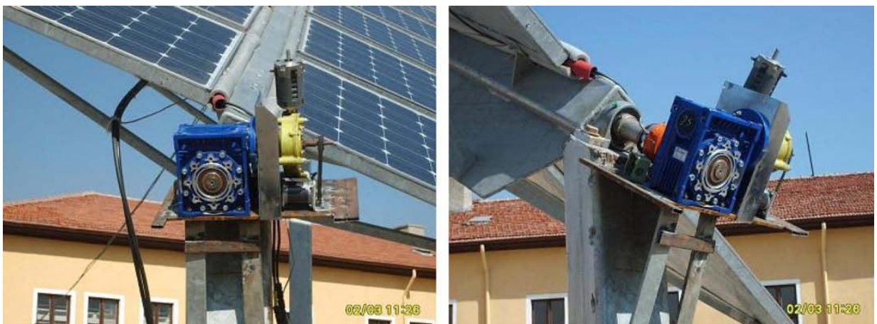
Figura 2.5 - Conexão da caixa de engrenagens ao motor c.c. Fonte: (SEFA, DEMIRTAS e ÇOLAK, 2009)
