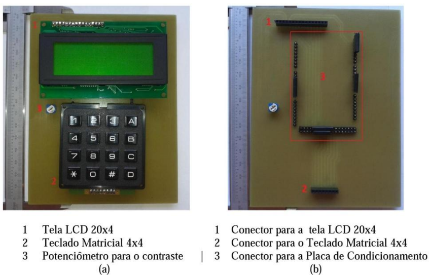
Figura 24. Placa de Interface Homem-Maquina: (a) Componentes e (b) Conectores.
