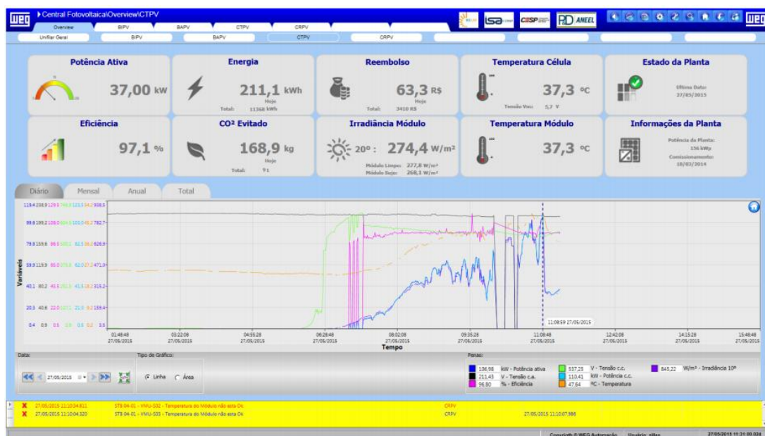
Figura 5.6 - Sistema SCADA da Usina Solar do IEE/USP.
