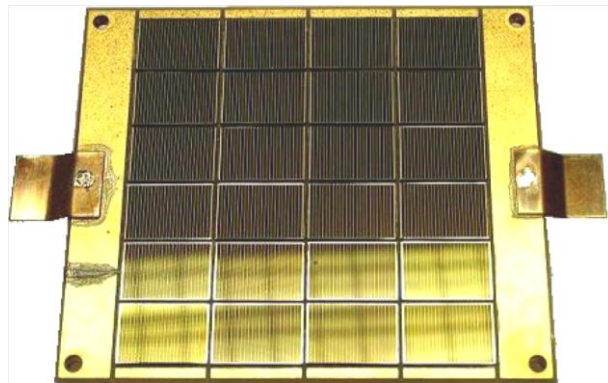
Figura 3.9 - Montagem de arranjo com 24 células de alta concentração, 100\text{ cm}^2 .
